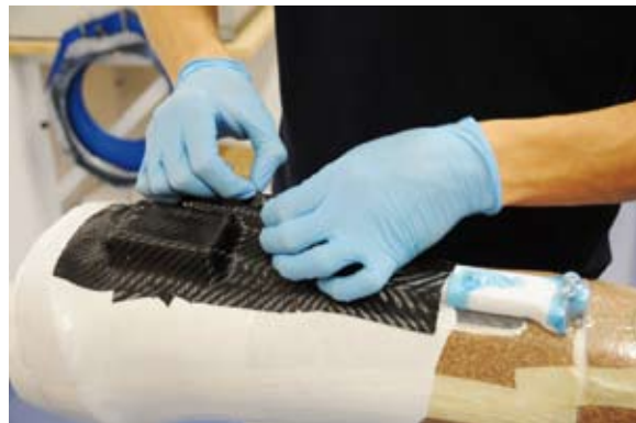
High-Tech: Anfertigung einer PrePreg-Orthese mit eingearbeitetem E-Mag Active
